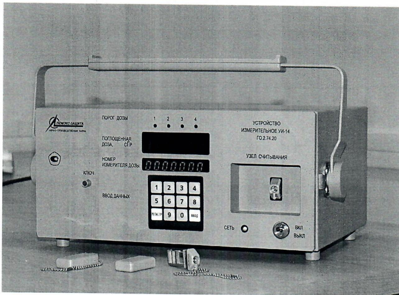
Устройство измерительное УИ-14 предназначено для измерения поглощенной дозы гамма-излучения, зарегистрированной измерителем дозы ИД-14 (ИД-11).
