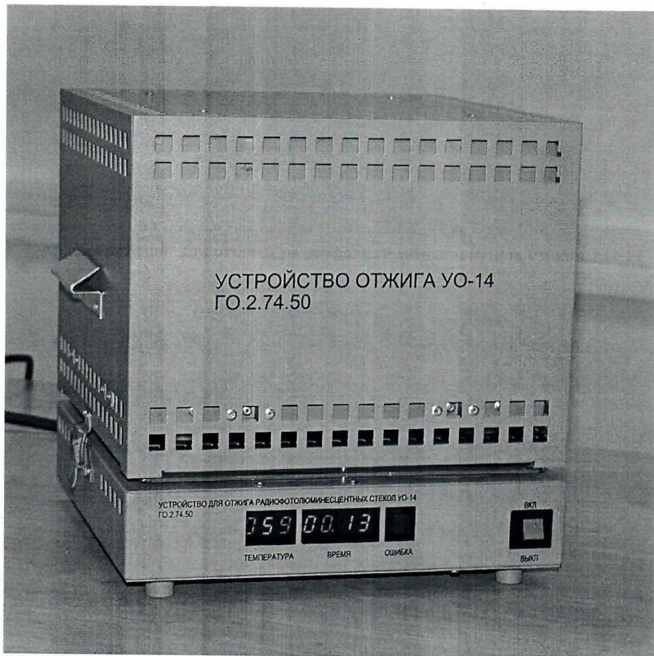
Устройство для отжига радиофотолюминесцентных стекол УО-14 предназначено для автоматизированного отжига (обнуления показаний) радиофотолюминесцентных стекол, входящих в состав измерителей дозы ИД-14.
