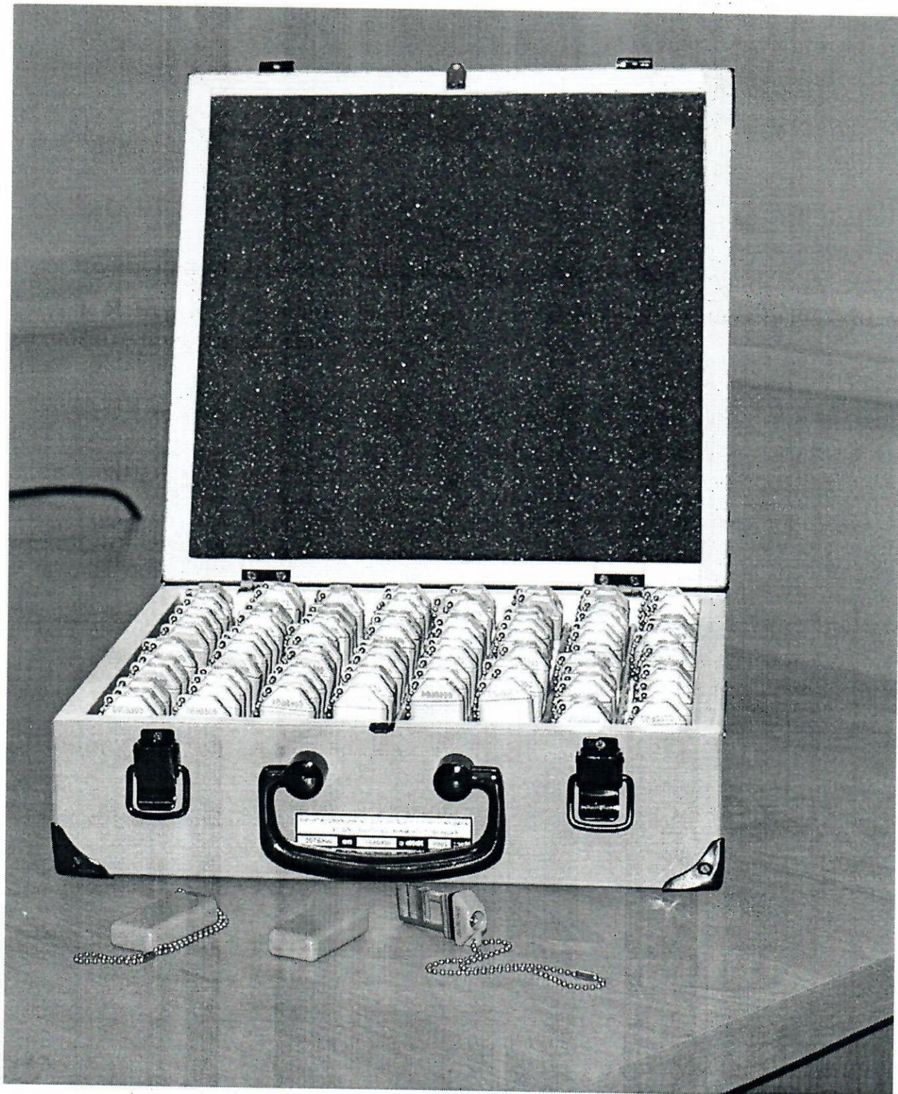
Измеритель поглощенной дозы гамма-излучения индивидуальный радиофотолуминесцентный ИД-14 предназначен для регистрации поглощенной дозы гамма-излучения.
